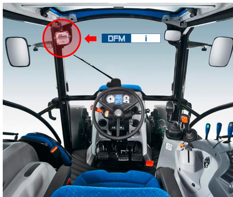
Рисунок 11 — Пример места установки DFM i в кабине водителя трактора
