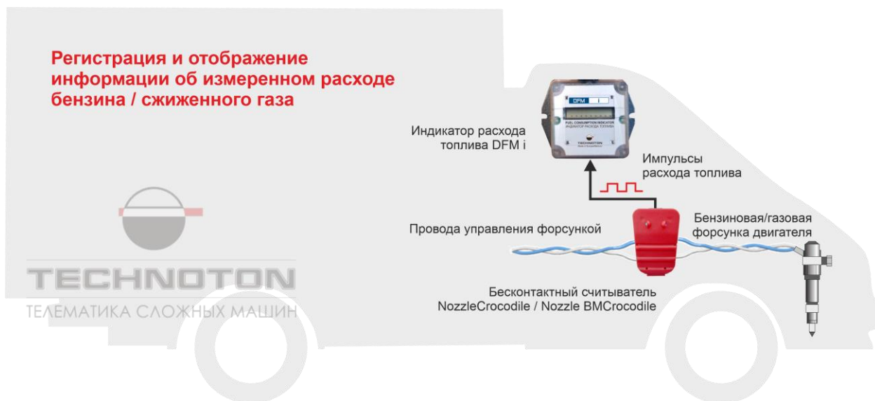
б) использование DFM i совместно с бесконтактным считывателем NozzleCrocodile/Nozzle BMCrocodile на LCV технике
