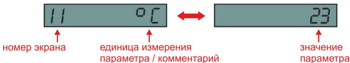
Рисунок 8 — Отображение информации на дисплее DFM i
