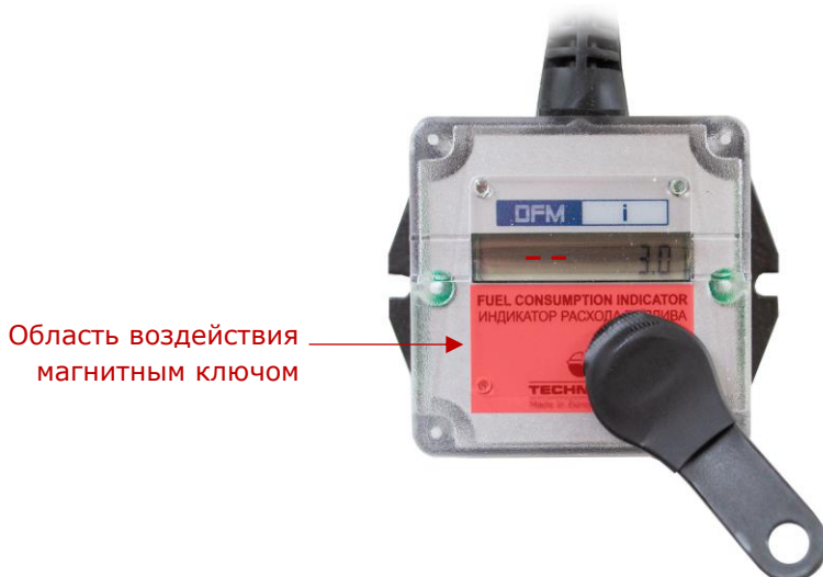
Рисунок 6 — Переключение информационных экранов дисплея DFM i
