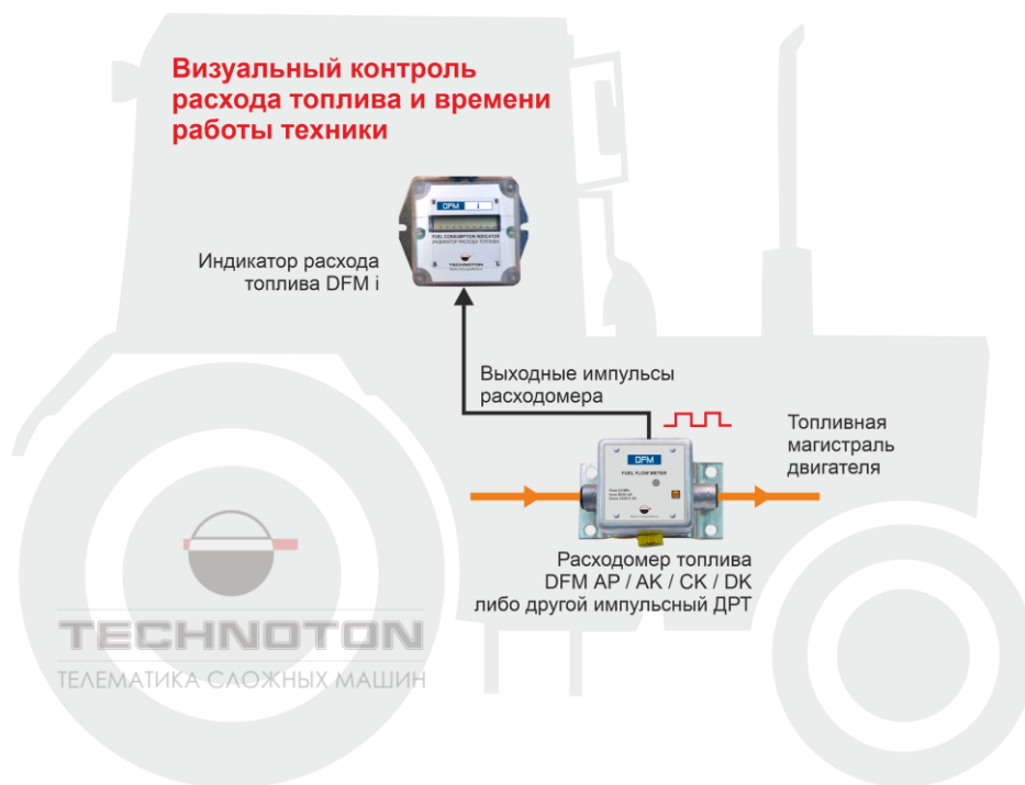
а) использование DFM i совместно с проточным импульсным расходомером топлива DFM на автотракторной технике
