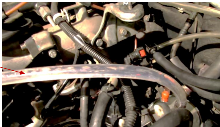
Рисунок 4 — Визуальное определение наличия воздуха в топливе
