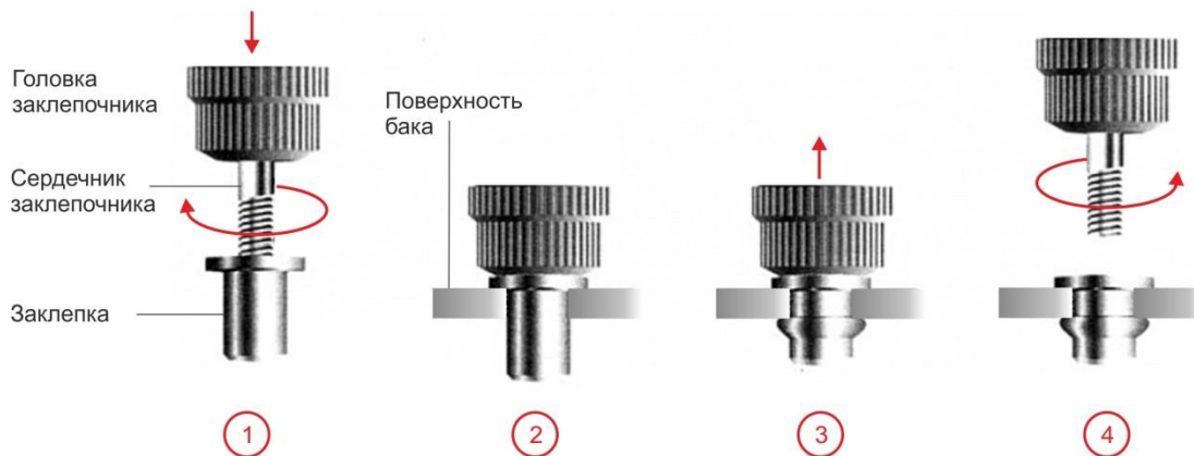
а) порядок установки резьбовых заклепок
