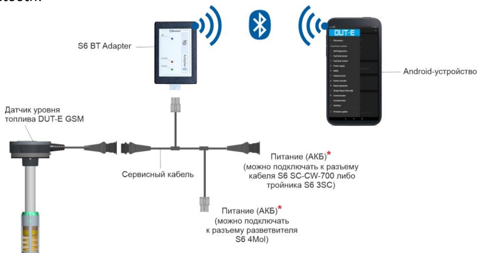
а) подключение датчика с помощью S6 BT Adapter
