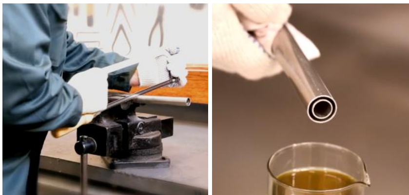
Рисунок 16 — Обрезка измерительной части DUT-E GSM и промывка среза топливом
