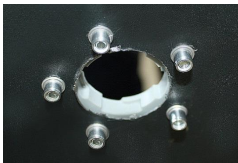
б) вид установленной крепежной пластины изнутри бака
