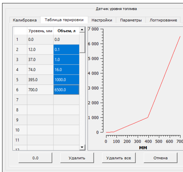
Рисунок К.1 — Пример записи в тарифовочную таблицу с помощью ПО Service S6 DUT-E значений объема топлива с измененной дискретностью
