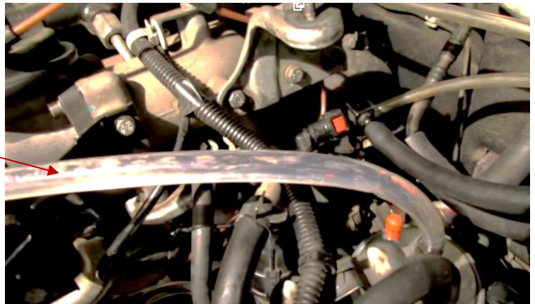
Рисунок 5 — Визуальное определение наличия воздуха в топливе
